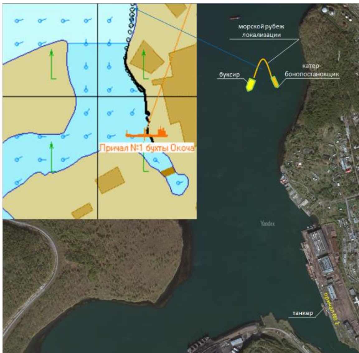
Рисунок 2.6-1. Модель постановки морского рубежа локализации
